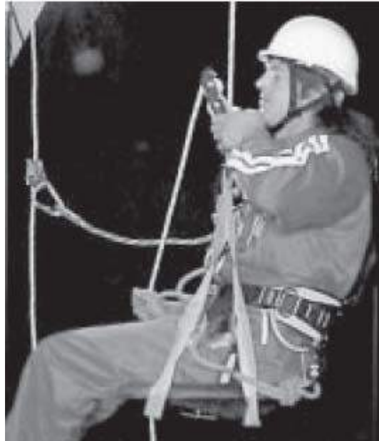
Figura 1 Descenso mediante descendedor autoblocante y dispositivo anticaídas
