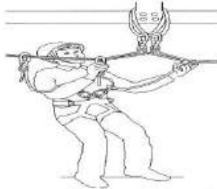
Figura 4 Progresión horizontal sobre una estructura utilizando tres cabos de anclaje
