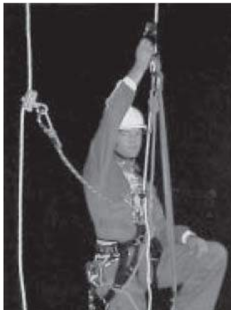
Figura 2 Sistema clásico: Ascenso mediante puño autoblocante y autobloqueador ventral
